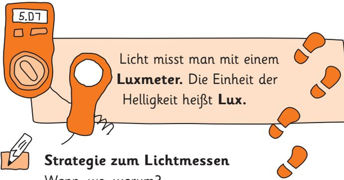
Licht misst man mit einem **Luxmeter**. Die Einheit der Helligkeit heißt **Lux**.
