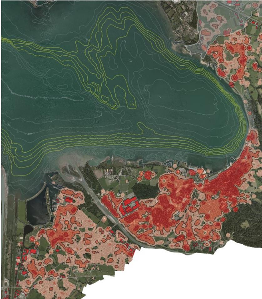
*Die Abbildung zeigt die ermittelten derzeitigen Wärmebedarfsdichten. Insgesamt zeigt sich, dass die Wärmebedarfsdichten in einem für eine Fernwärmeversorgung günstigen Bereich liegen. Gut zu erschließen sind die Bereiche ab 250MWh/a, aber auch darunterliegende Gebiete können durch geschickte Leitungsführung erschlossen werden.*
