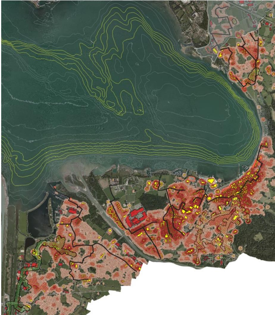
*Mögliche Trassenverläufe basierend auf möglichen Standorten der Energiezentralen, den modellierten aktuellen Wärmedichten, den bereits bestehenden und geplanten Wärmenetzen sowie größeren Kunden (in Gelb hervorgehoben)*
