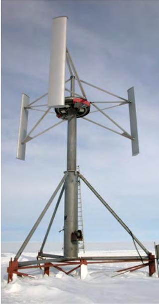
ABBILDUNG 232: H-Rotor, 20 kW, 20 m BILD: Eget Arbete
