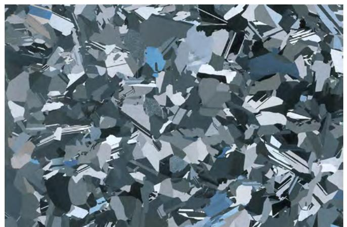
ABBILDUNG 260: Struktur von polykristallinem Silizium - BILD: Armin Kübelbeck
