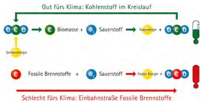
ABBILDUNG 131: Kohlenstoff im Kreislauf oder Einbahnstraße fossile Brennstoffe - QUELLE: Österreichischer Biomasse-Verband
