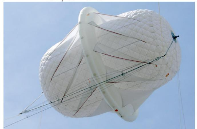
ABBILDUNG 234: Schema einer turmlosen Windkraftanlage
