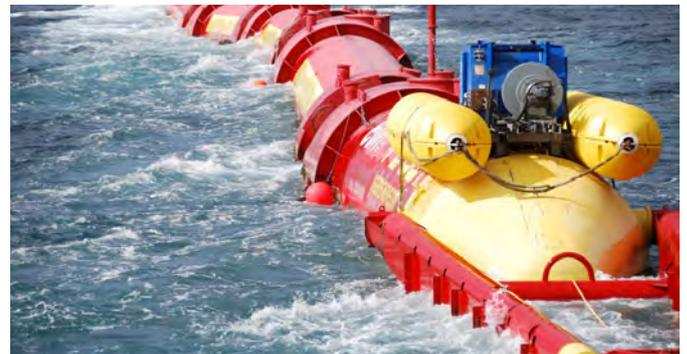
ABBILDUNG 222: Wellenkraftwerk Pelamis, 750 kW bei 150 m Länge
