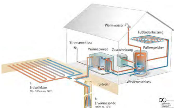
ABBILDUNG 272: Schema der Wärmepumpe - QUELLE: Agentur für Erneuerbare Energie: [www.unendlich-viel-energie.de](http://www.unendlich-viel-energie.de)
