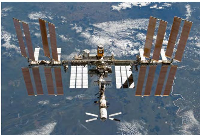
ABBILDUNG 251: Raumstation ISS, 120 kW aus 4.500m<sup>2</sup> Solarzellenfläche
