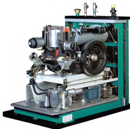
ABBILDUNG 202: Schnittmodell eines Pflanzenöl-BHKW, 5kW elektrisch, 10kW thermisch - BILD: SenerTec
